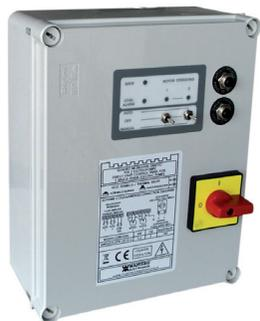
**Version 1 pompe** : Permet la marche automatique et la protection de la pompe par l'intermédiaire de 2 flotteurs. Equipée d'une alarme visuelle signalant un défaut de fonctionnement par l'intermédiaire d'un flotteur alarme.
